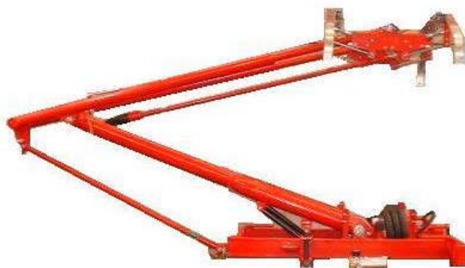
Pantografo monobraccio per locomotiva E602B Single-arm panto for E602B loco Pantographe monobras for E602B loco
